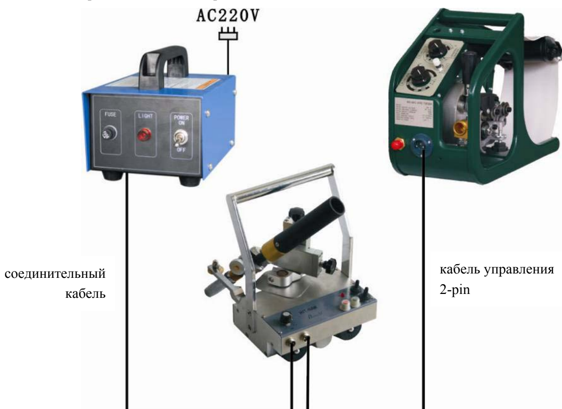
Рисунок 6: Подключение сварочной каретки HIT-NAW
