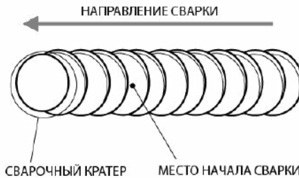
Рис. 11.2.2. Начало сварки при смене электрода.
